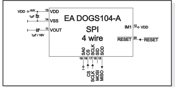
Um eine fehlerfreie Funktion und Initialisierung des Displays zu gewährleisten, empfehlen wir den Reset aktiv zu bedienen. Dies kann entweder über einen Port des Mikrokontrollers geschehen oder mittels Resetschaltung. Hier ein Anwendungsbeispiel:
