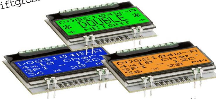
Abmessungen 36,0 x 27,5 x 4,6 mm
