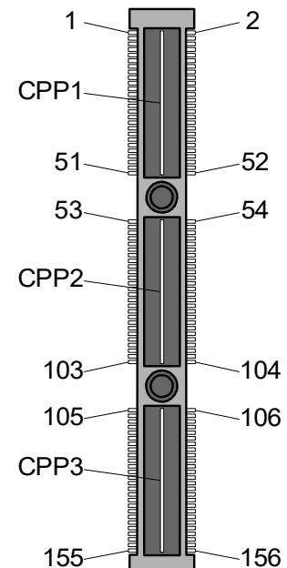
**Figure 20:** PCIe/104 Connector (Samtec, ASP-129637-03)
