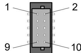
**Figure 24:** Fan Connector (Hirose, DF11CZ-10DS-2V)
