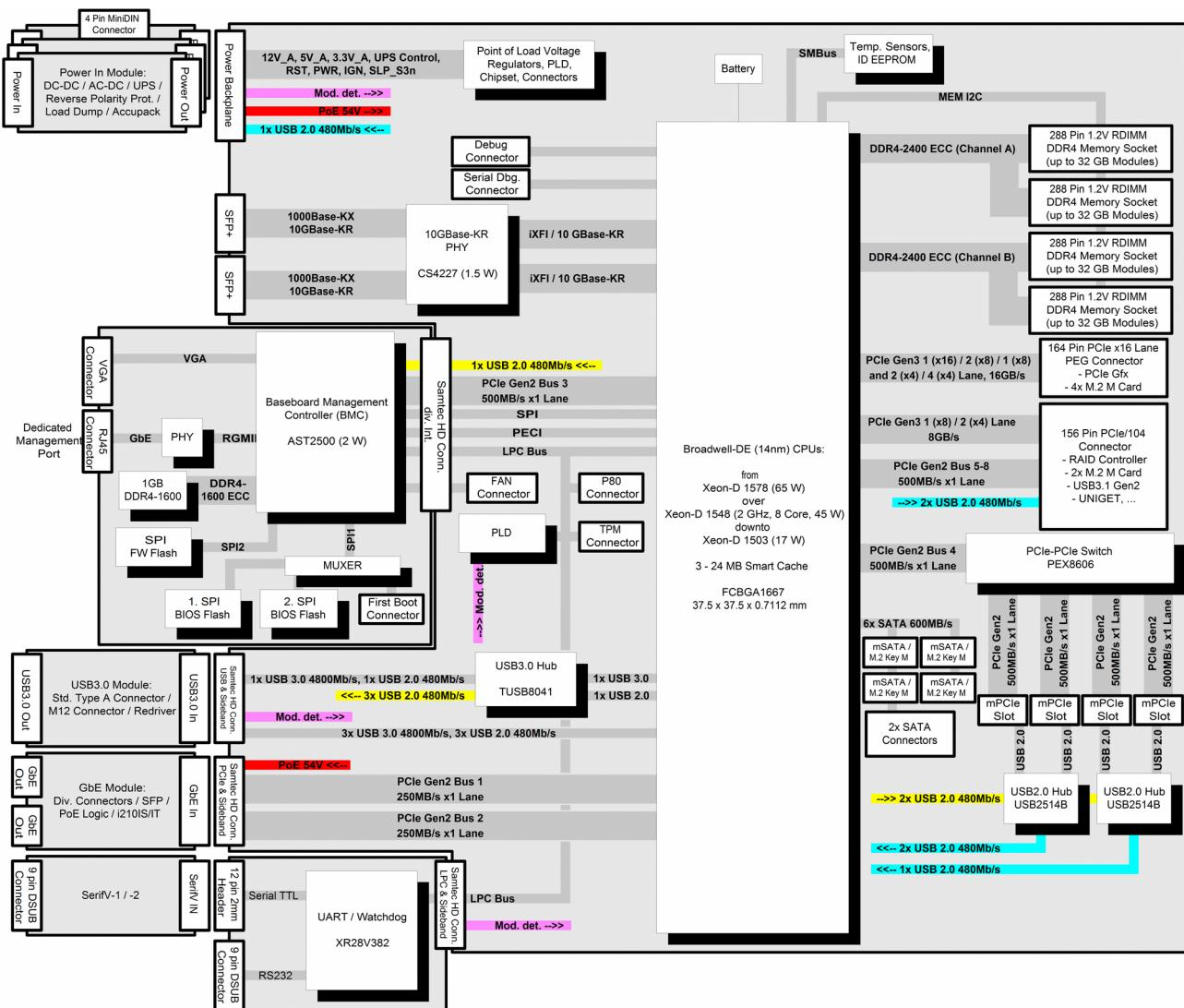
Figure 26: Complete MXCS Block Diagram
